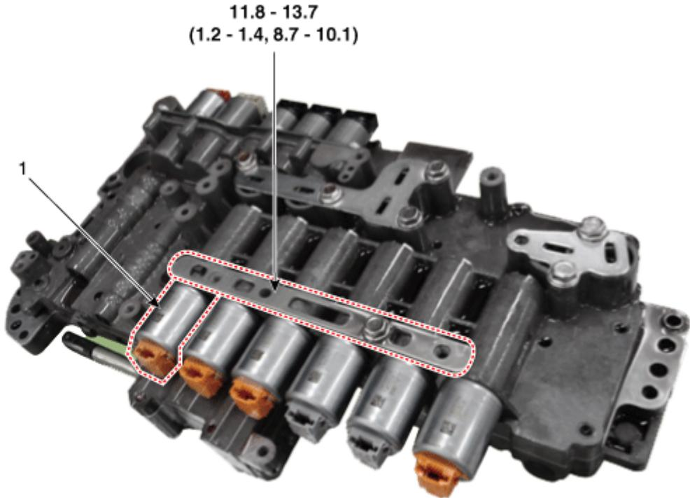
**Tightening torque: N·m (kgf·m, lb·ft)**
